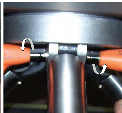
3. Затяните винты (шестигранник 5 мм)
